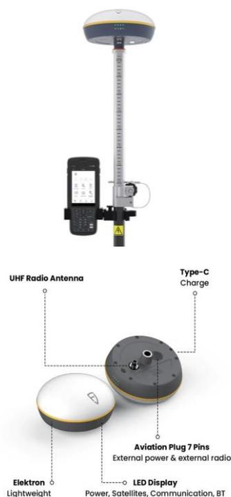
La serie Trion V1t de FJD, receptor GNSS RTK versátil y ligero, proporciona rápidamente posiciones precisas en entornos difíciles con cobertura de señal global. V1t, la versión avanzada, está diseñado con una unidad de medición inercial (IMU) que permite corregir la posición correcta durante la medición.
